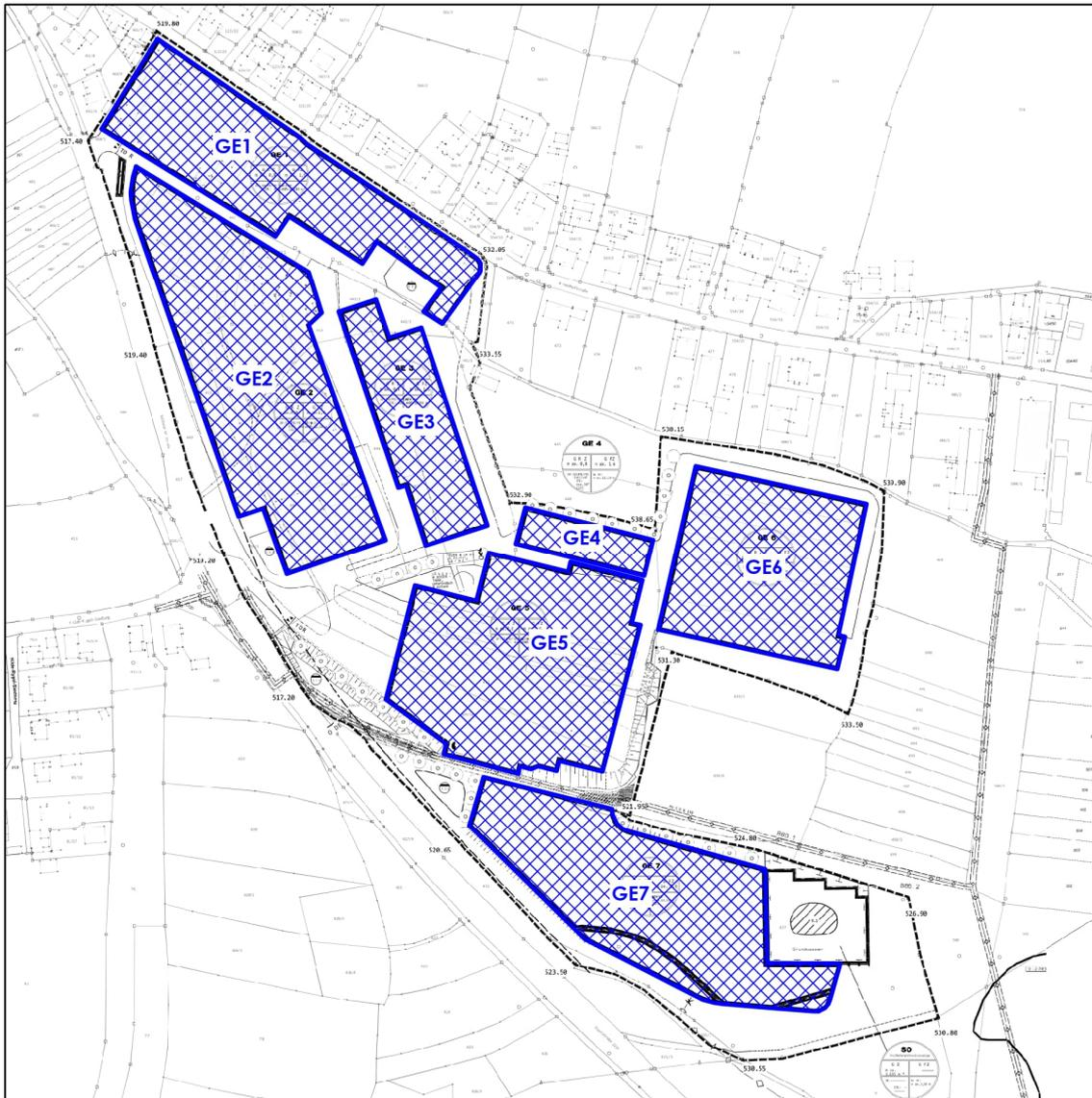
Abbildung 12: Darstellung der relevanten Emissionsbezugsflächen  $S_{EK}$
