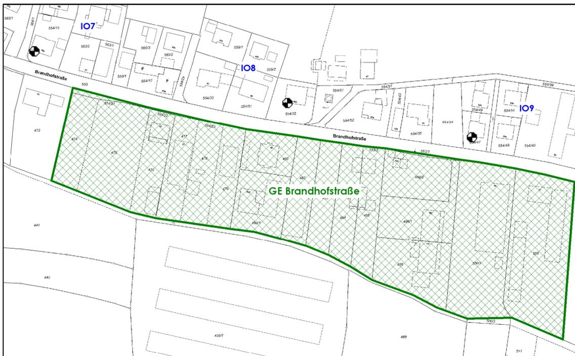
Abbildung 9: Lageplan mit Darstellung der idealisierten Flächenschallquelle zur Ermittlung der Vorbelastung durch das Gewerbegebiet an der Brandhofstraße
